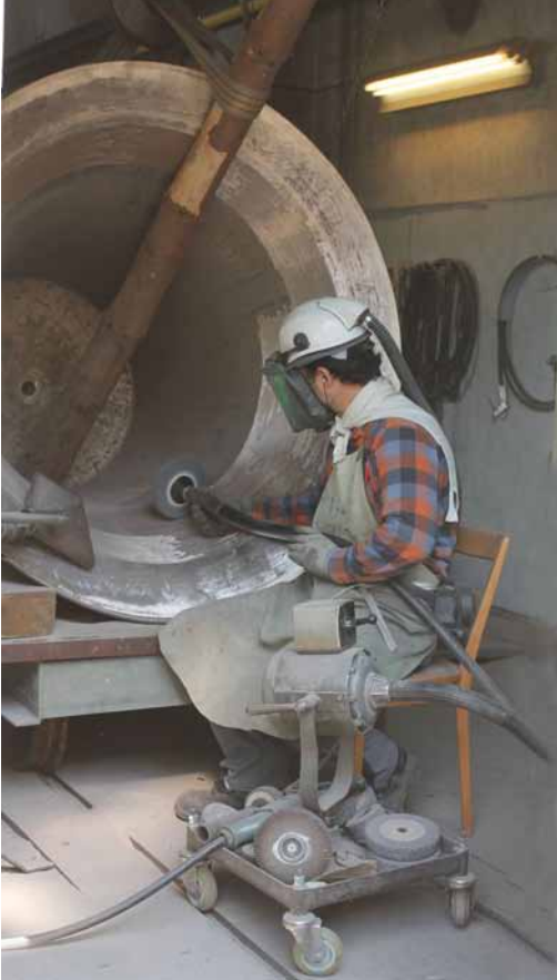
Hier wird die neugegossene Glocke geschliffen, um sie zu stimmen.
