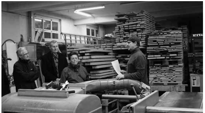
Das Gestell und ein Teil der Orgelpfeifen sind aus Holz. Die Firma Metzler stellt alles selber her, angefangen von der Auslese der Holzstämmen (vor allem Eiche, aber auch Kirschbaum und andere) über das Sägen, die Lagerung und Lufttrocknung des Holzes.
