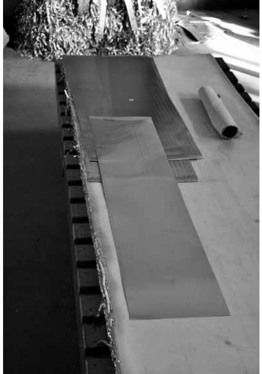
Für die Weiterverarbeitung werden die Metallplatten in die jeweils benötigte Dicke gehobelt.
