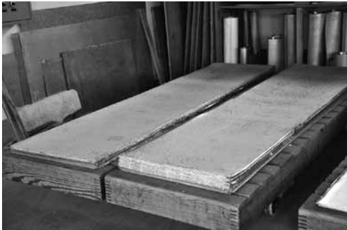
Das Pfeifenmetall wird in lange, dünne Platten gegossen.
