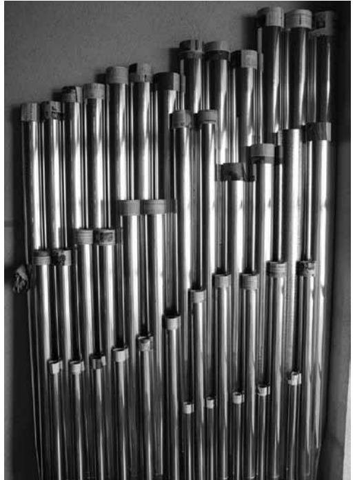
Aus den Blechen werden die Pfeifen gerollt und zusammengelötet.
